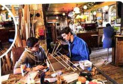
**1. Clément décide du nombre de joueurs,** prend des mesures pour les baguettes, et trace les cages, qu'il découpe au cutter. Il fait des trous pour les baguettes et vérifie qu'elles rentrent et tournent bien.
