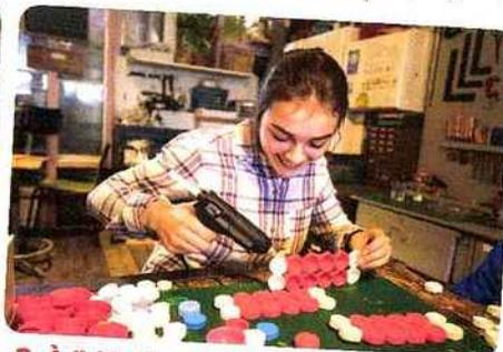
**2. À l'aide d'un pistolet à colle chaude,** Blanche assemble les bouchons par lignes de six... Puis colle ces lignes ensemble, pour obtenir des carrés de 6 x 6 bouchons. Attention aux doigts!
